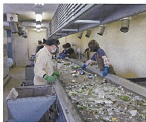
2 カレット手選別コンベヤ Cullet sorting conveyor
