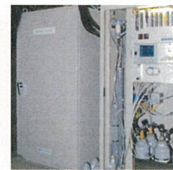
燃焼ガス分析計 Flue gas analyzer 燃焼ガスに含まれる一酸化炭素、窒素酸化物、硫酸酸化物、塩化水素、ばいじんの濃度を計測することができます。
