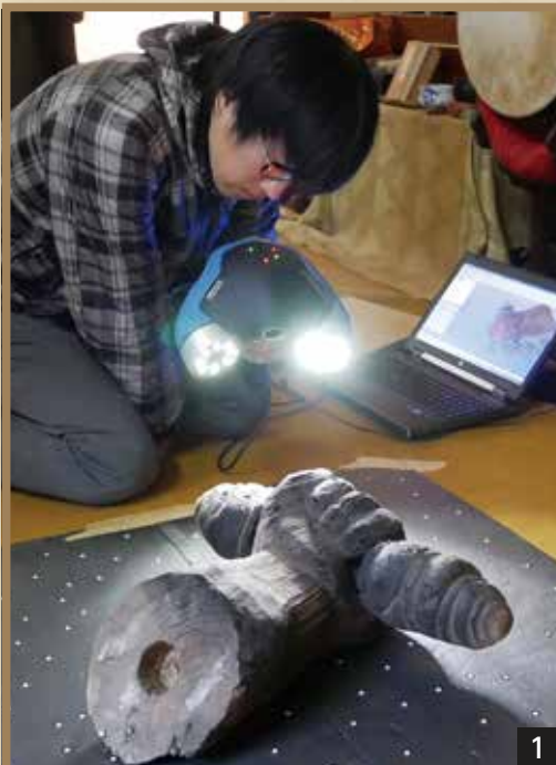
1.ハンディースキャナを使った3Dデータ取得作業 2.3Dプリンターで出力したイノシ型土製品 3.3Dプリンタで出力する様子を子どもに説明(令和元年8月)
